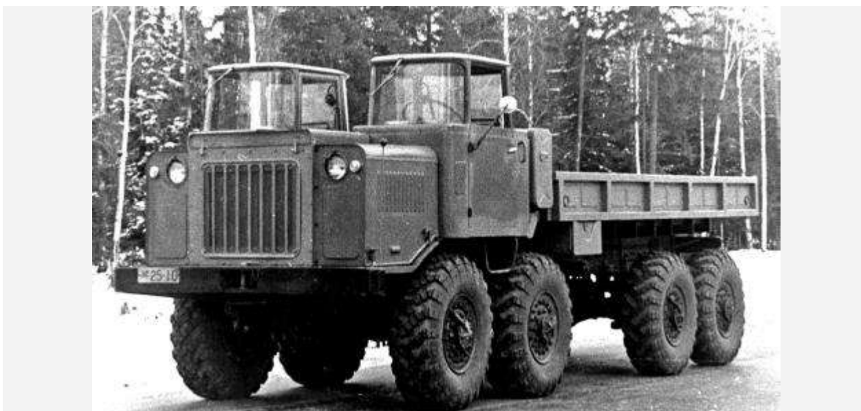
Автомобиль НАМИ-058 (8x8) с 275-сильным дизелем V12 и двумя кабинами. 1960 год
